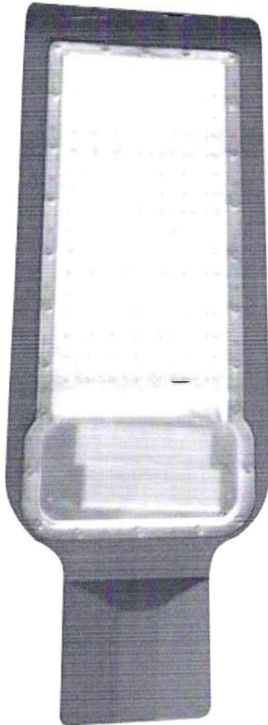
Este Poste de Iluminação Pública Pétala LED é ideal para iluminação pública/ambientes externos. Driver led isolado bivolt automático(85~265Vac), dissipador de calor na parte superior e proteção IP66 "Corpo" em alumínio com pintura eletrostática, LED's de alto fluxo luminoso(110Lm/W) montados em placa de alumínio interna com lentes convexas frontais que otimizam e dissipam melhor a iluminação, 120° de abertura do feixe luminoso, sistema para fácil e rápida fixação.
