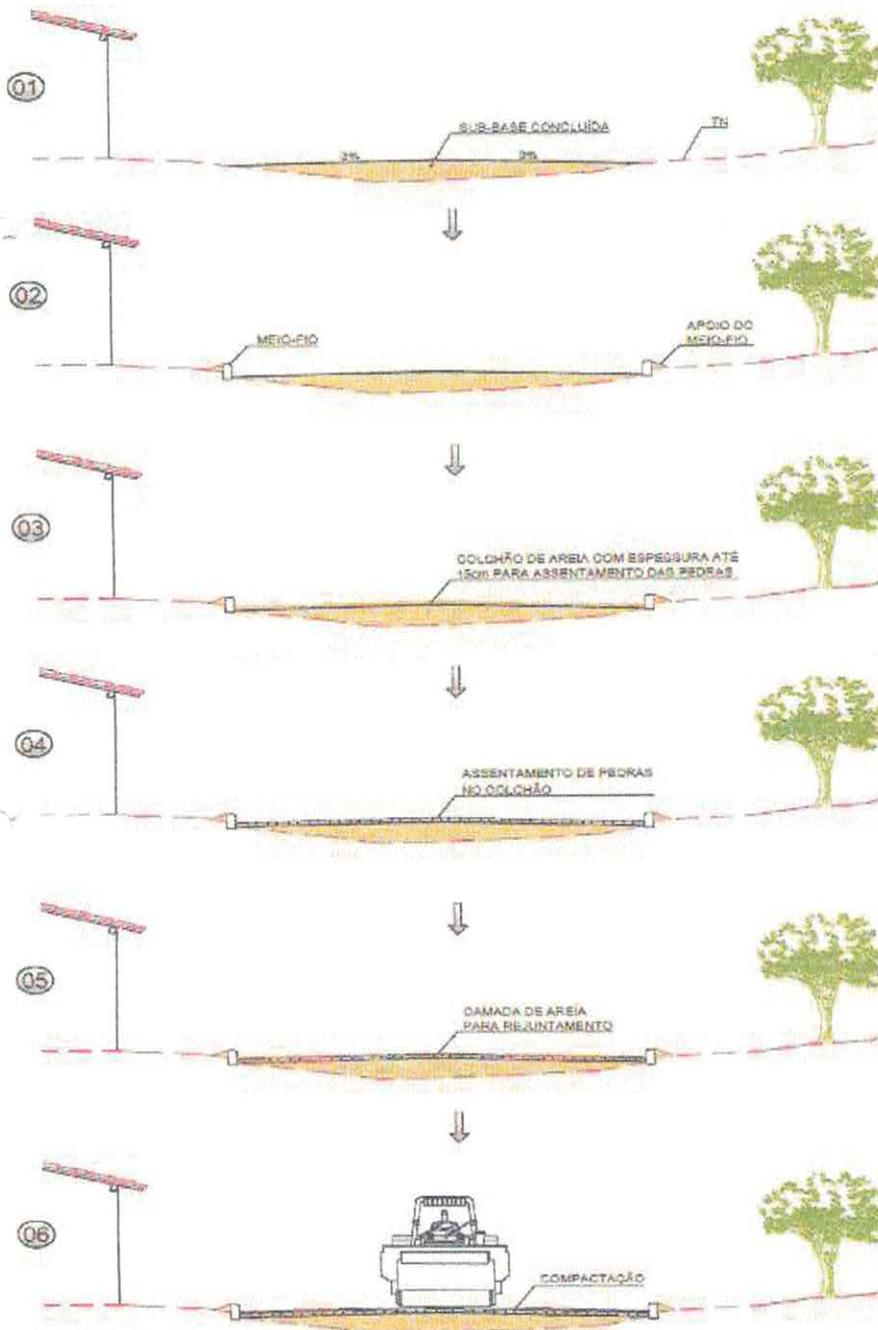
AS OBRAS DE TERRAPLENAGEM DE DRENAGEM DE REGULARIZAÇÃO E ESTABILIZAÇÃO DA CAMADA QUE SERVIRÁ DE BASE DO CALÇAMENTO (ESPECIALMENTE UMA CAMADA DE BLOCO OBEDECENDO AS ESPECIFICAÇÕES DE SUB-BASE, DER-ES-P 03/00) OU RECONFORMAÇÃO DA PLATAFORMA DEVERÃO ESTAR CONCLUÍDAS.
